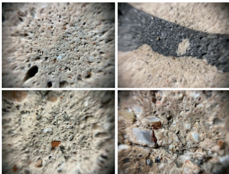
Fot. 26–29. Fotografie makro różnych fragmentów posadzki krypty: a – część dekorowana, partia tła, b – część dekorowana, partia rysunku, c – część niedekorowana w absydzie, d – część niedekorowana, strona północna. Zestawienie fotografii pozwala zaobserwowanie znacznych różnic w morfologii części niedekorowanych oraz dekorowanych, 2021, fot. M. Stec
